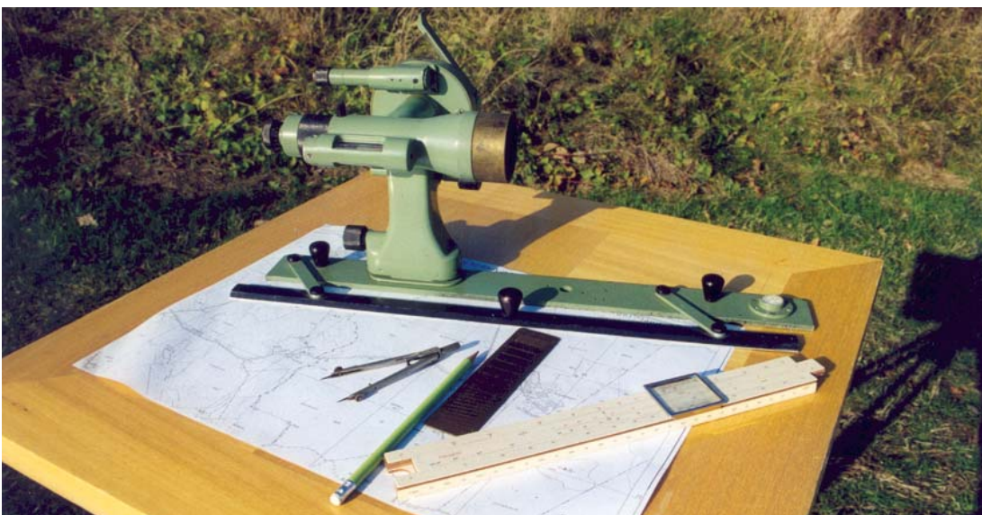
Abb. 6: Topographische Aufnahme-technik, Messtisch und Kippregel
