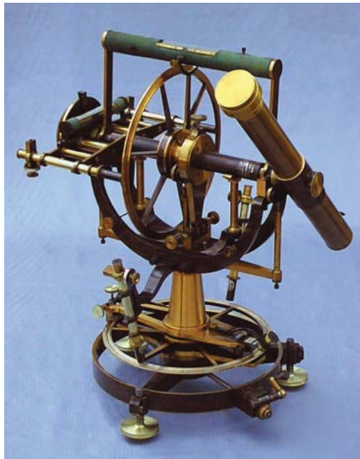
Abb. 6: Universalinstrument von Pistor und Martins 1862
